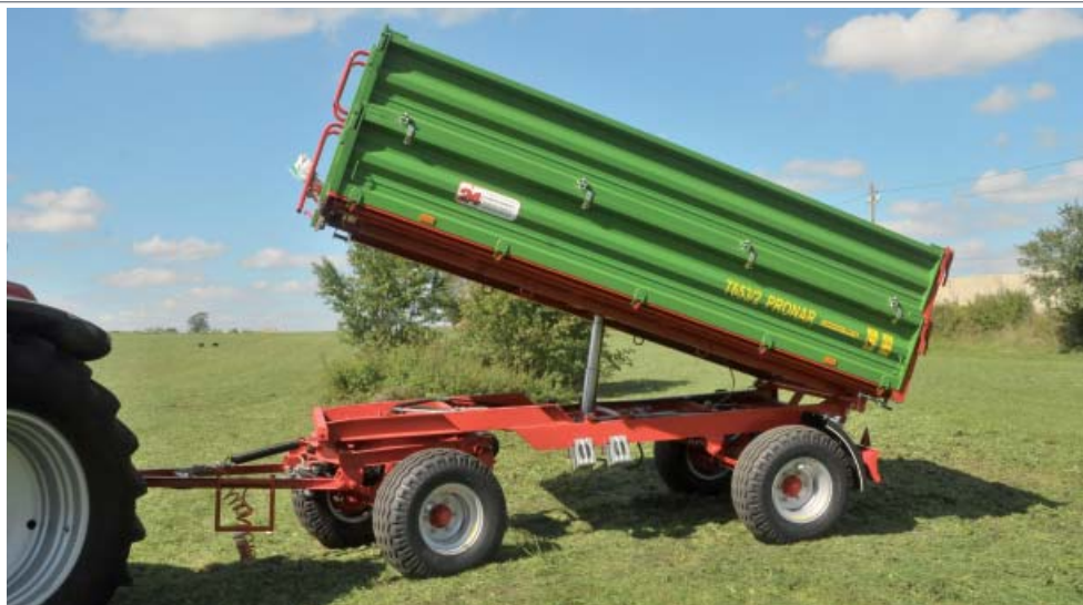
W przyczepie PRONAR T653/2 zamontowano instalację trójstronnego wywrotu z cylindrem teleskopowym o ciśnieniu 200 barów
