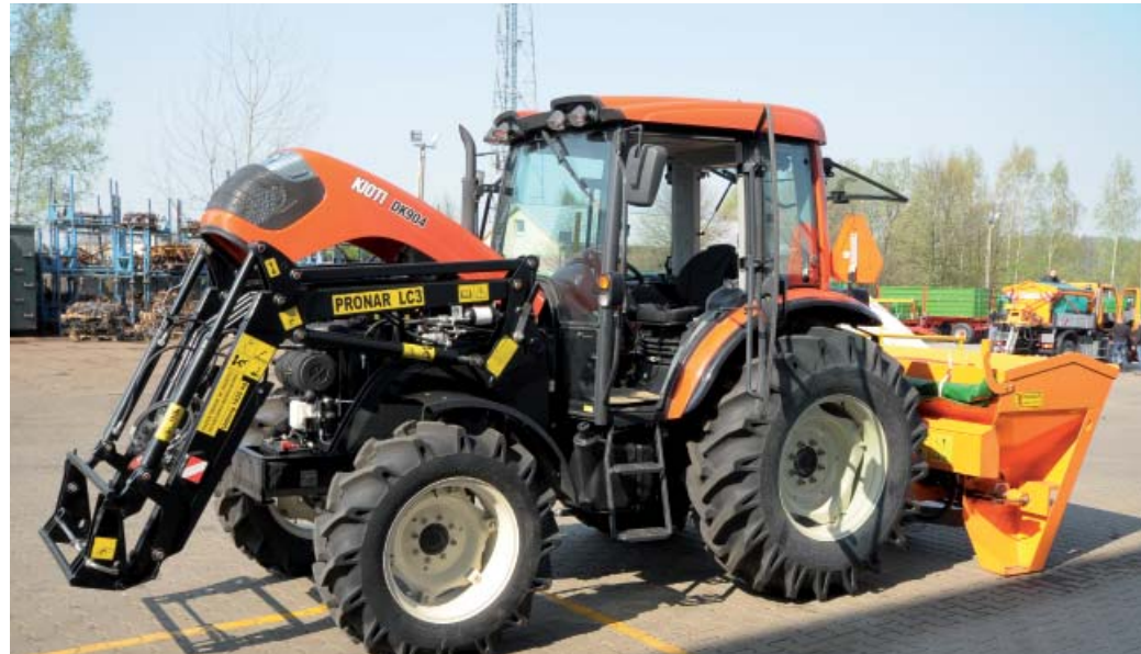
Ładowacz PRONAR LC3 został zaprojektowany tak, aby zminimalizować jego masę i zwiększyć udźwig
