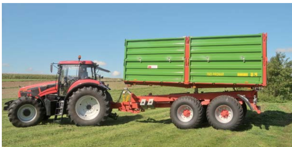
Oprócz transportu materiałów sypkich, przyczepą PRONAR T683 można przewozić też ładunki na europaletach, skrzyniopaletach oraz pasze w belach o szerokości do 1,2 m
