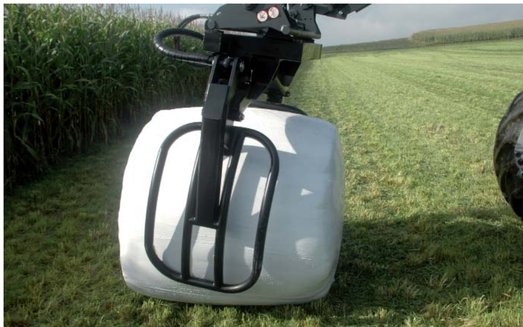
Konstrukcja chwytaka zabezpiecza belę przed uszkodzeniem
