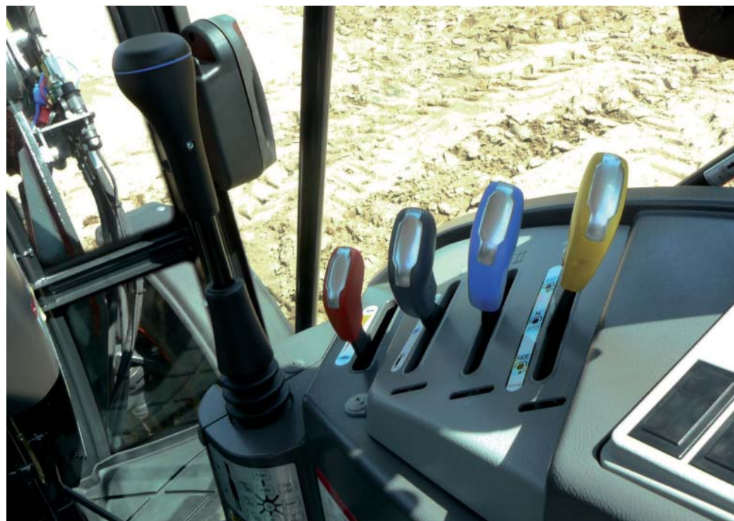
Ciągniki Kioti są standardowo wyposażone w rozdzielacze hydrauliczne wraz z ergonomicznymi joystickami
