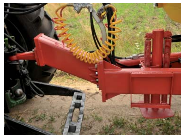
Hydrauliczna prosta podpora dyszla z odcinającym zaworem kulowym
