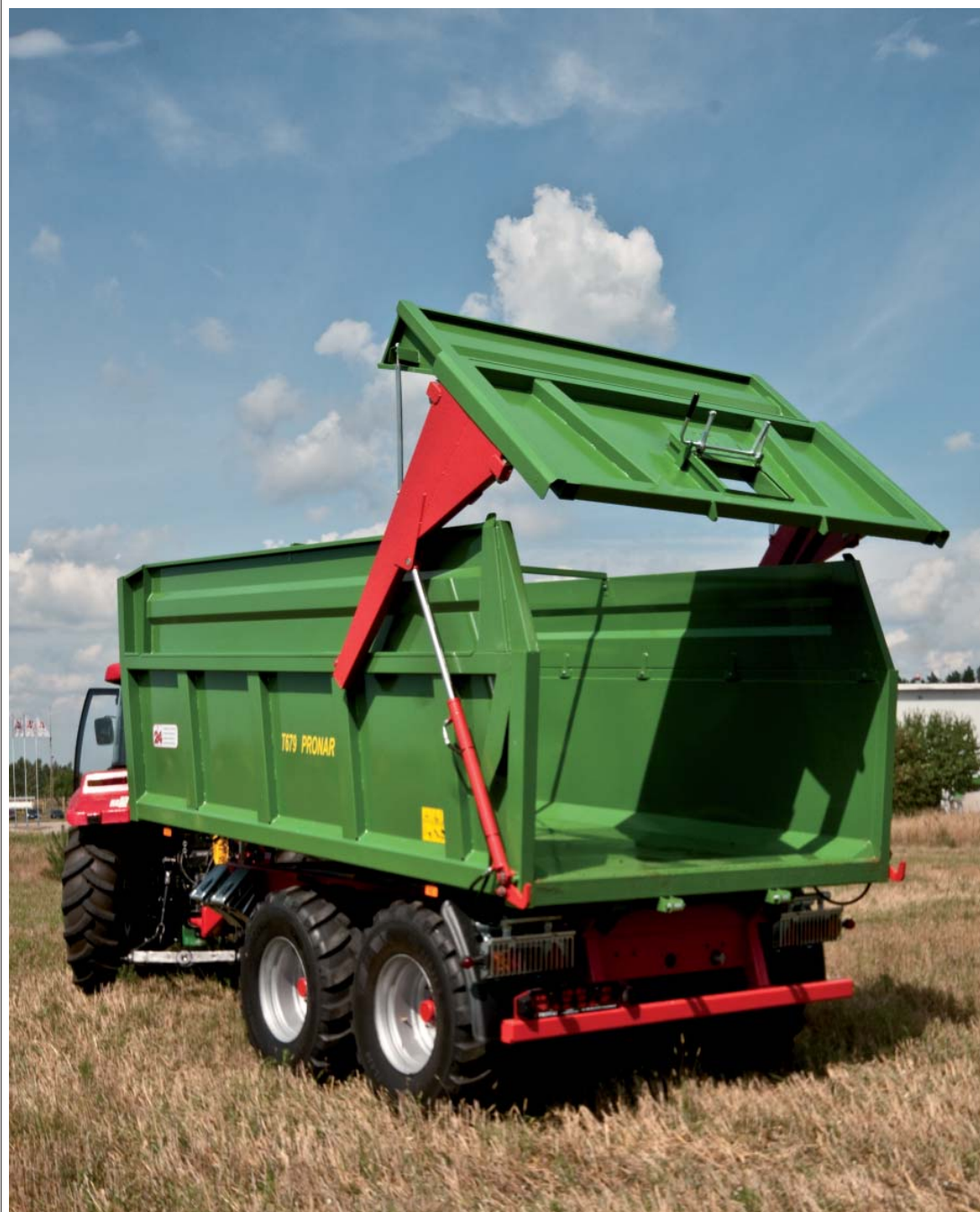
Trapezowaty kształt skrzyni przyczepy T679 przyspiesza i usprawnia wyładunek
