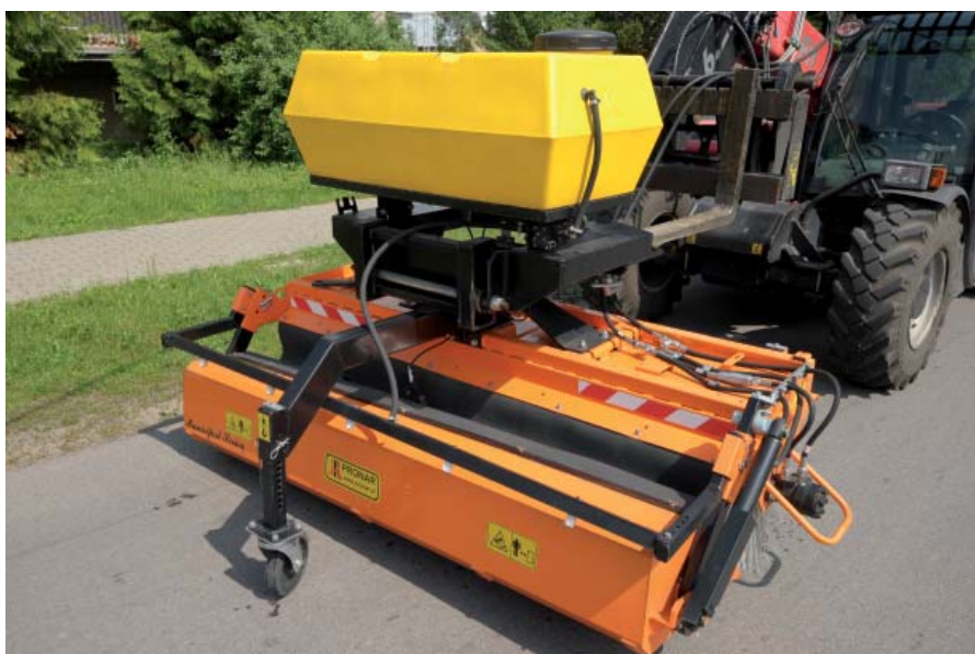
Układ zraszania zamiatarki Agata ZM-2000 z pojemnikiem na wodę pozwala zmniejszyć emisję pyłu i kurzu
