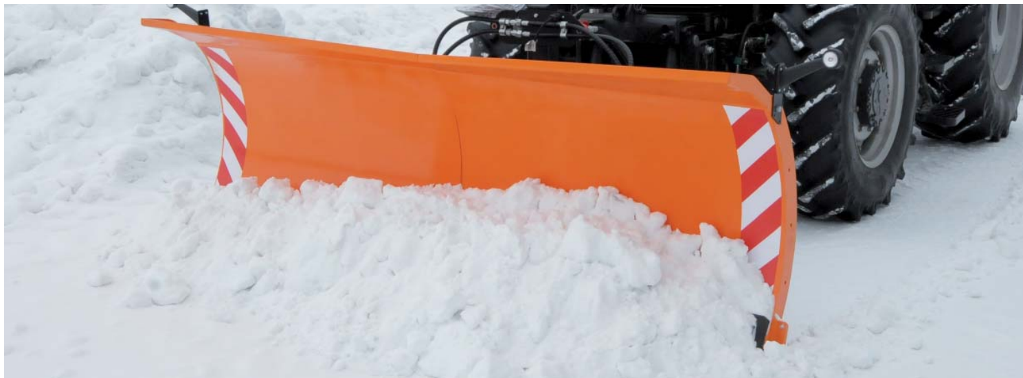
Specjalna konstrukcja odkładnicy pługu PRONAR PU-2600 oraz system jej wychylenia i amortyzacji sprężynowej zabezpieczają maszynę przed uszkodzeniem przy najechnaniu na ukrytą przeszkodę
