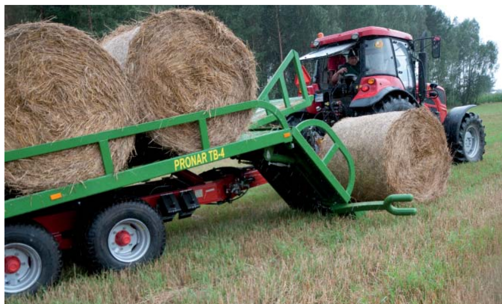
Hydrauliczny mechanizm załadunku unosi belę i umieszcza ją na przyczepie
