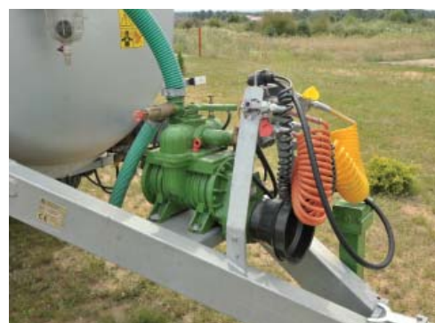
W zależności od pojemności, wozy asenizacyjne Pronaru wyposażone są w dwa typy kompresorów
