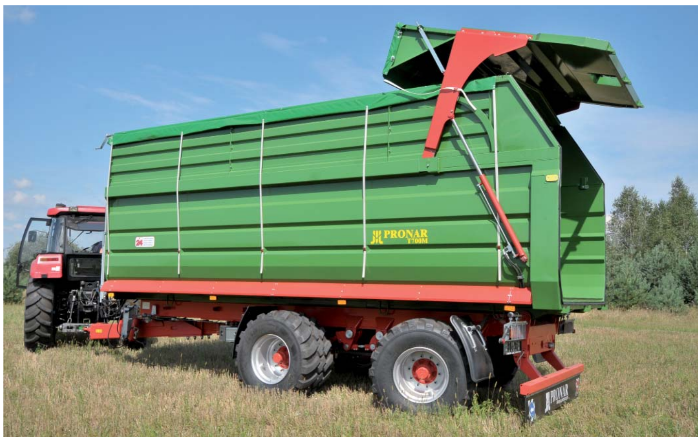
Przyczepa PRONAR T700M oferuje użytkownikowi ponad 16 ton ładowności i 35 m 3 pojemności
