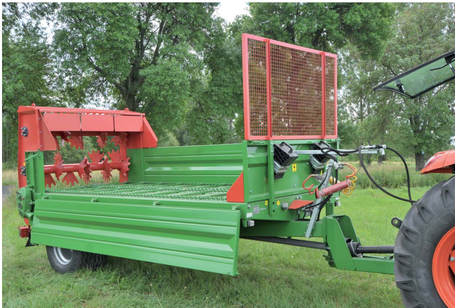
W rozrzutniku PRONAR N161 ściany boczne o wysokości 600 mm zapewniają pojemność skrzyni ładunkowej 4,1 m 3
