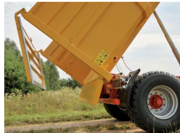
Wyposażenie przyczepy w hydraulicznie sterowaną tylną klapę, pozwala na łatwy załadunek i przewożenie maszyn budowlanych oraz drogowych
