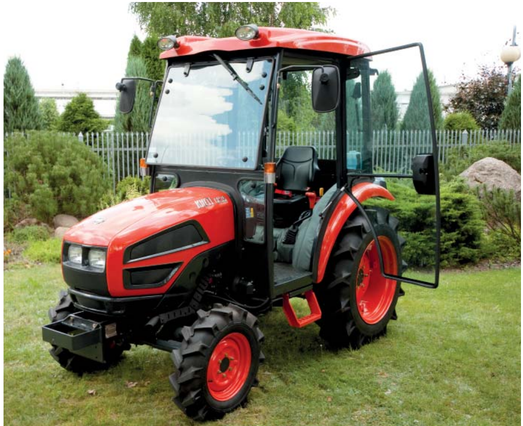
Ciągnik kompaktowy Kioti CK35, dzięki zwrotności i niewielkim rozmiarom, może dotrzeć do miejsc niedostępnych dla maszyn o większych gabarytach
