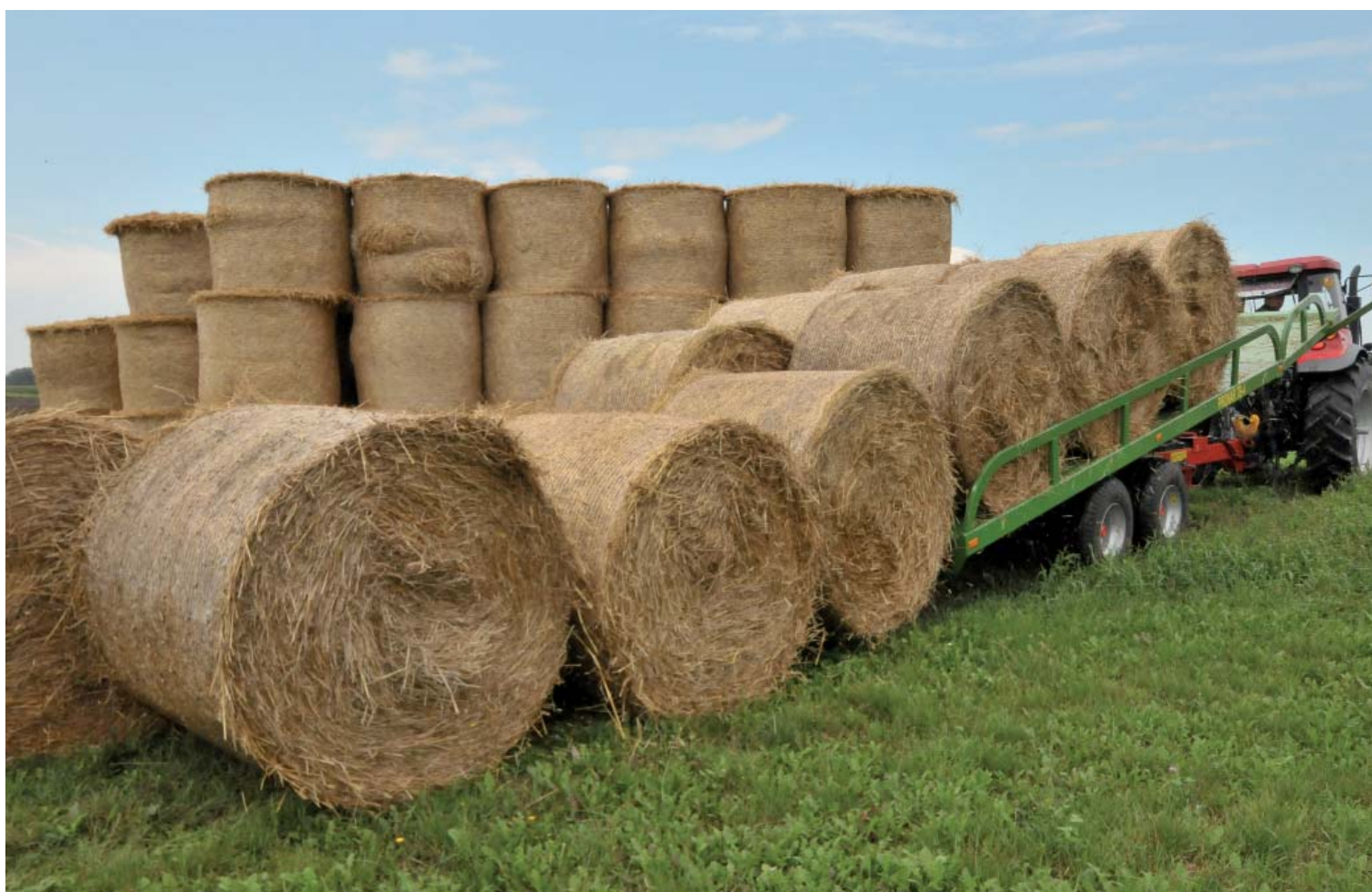
Szeroka platforma ładunkowa (2550 mm), umożliwia załadunek bel w dwóch rzędach
