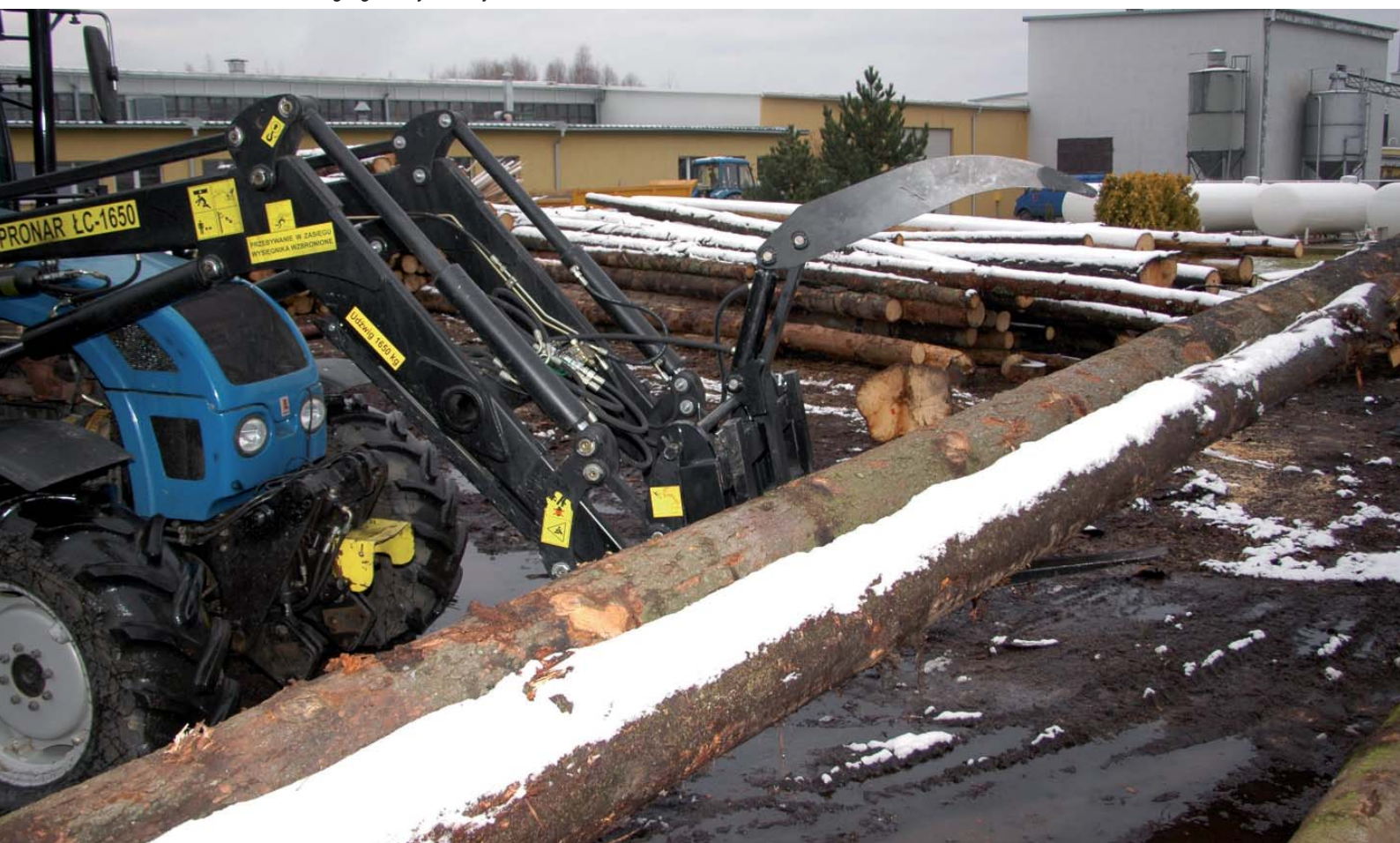
Ładowacz PRONAR ŁC-1650 zagregowany z chwytakiem do kłód
