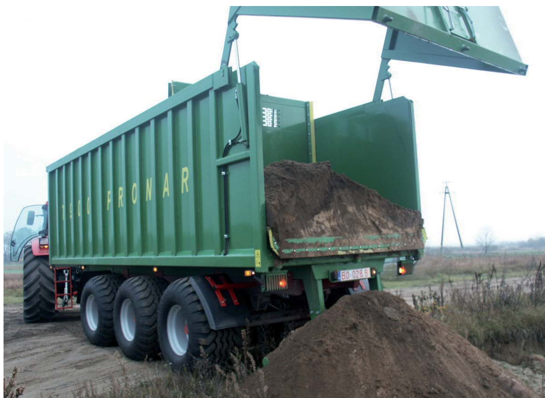
PRONAR T900 podczas ostatniej fazy wyładunku. Przednia ściana unosi się pod kątem 55 stopni
