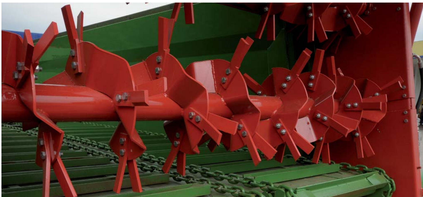
Zespół bębnow ślimakowych odpowiada za dokładne rozdrobnienie nawozu
