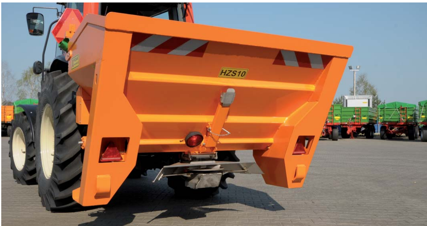
Uchylną łyżkę posypywarki samozaładowczej PRONAR HZS10 operator napełnia bez wysiadania z ciągnika
