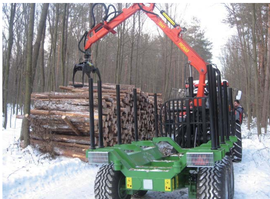
Rozstaw kłonic ramy nośnej przyczepy zapewnia możliwość transportu zarówno tzw. papierówki o długości 1,2 oraz 2,1 m, jak i dłużyc do 6,5 m
