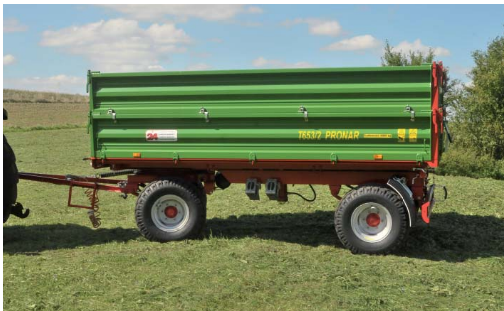
Przyczepa T653/2 jest wyposażona w skrzynię ładunkową o zarysie trapezowym
