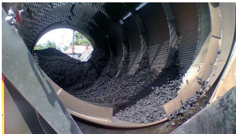
Zastosowanie odpowiednich wielkości oczek i właściwie ustawionych parametrów pracy bębna, pozwala otrzymać węgiel opałowy - groszek i ekogroszek
